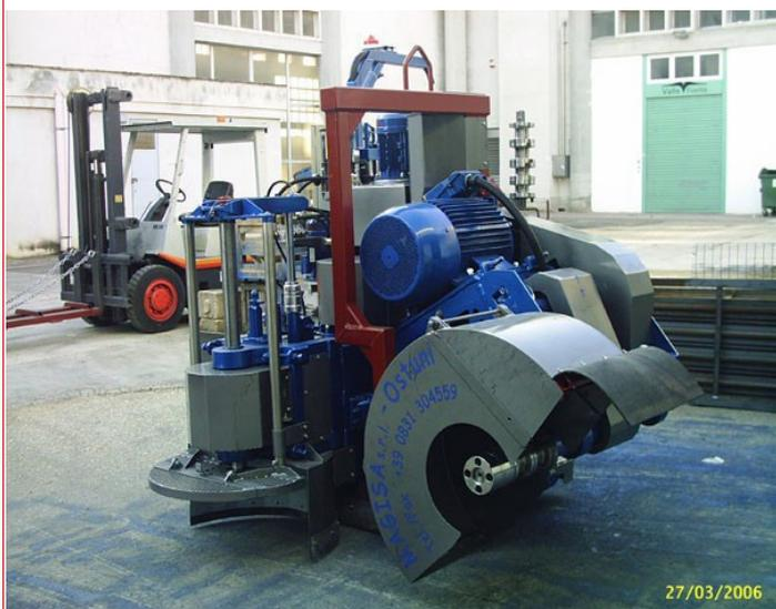
Adapto para cortar simultaneamente tanto em sentido horizontal como vertical com uma velocidade de corte de  $0 \div 25$  m/min.
