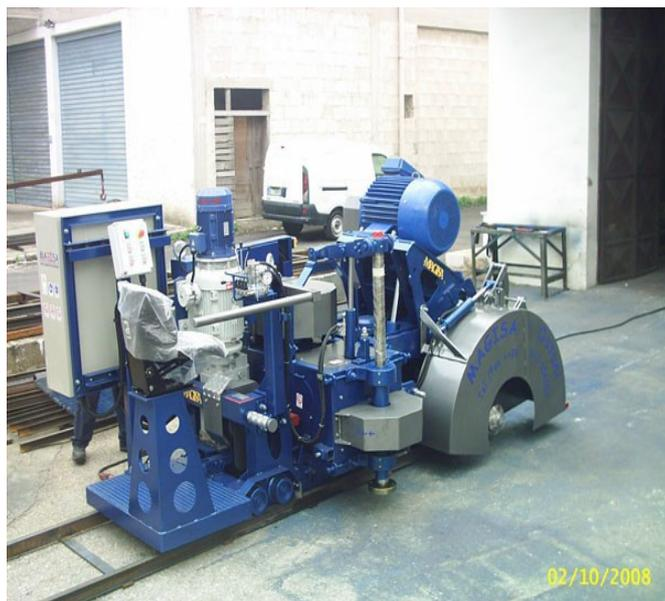
Adapto para cortar simultaneamente tanto em sentido horizontal como vertical com uma velocidade de corte de  $0 \div 25$  m/min.
