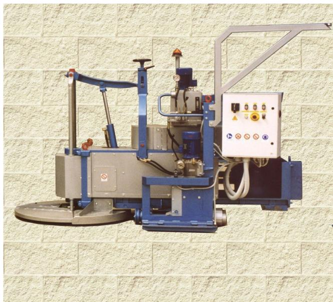
Adapto para cortar um sulco horizontal abaixo do plano de escavar com um velocidade de corte de 0 ÷ 25 m/min.
