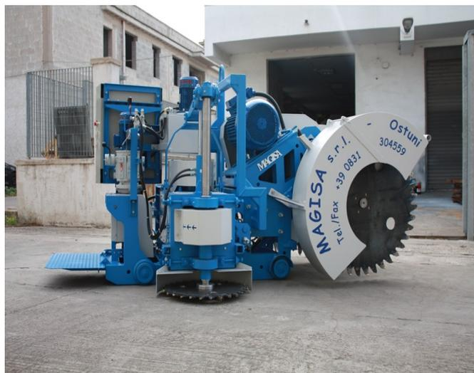
Adatto per tagliare contemporaneamente sia in senso orizzontale che verticale con una velocità di taglio da 0 + 25 m/min.
